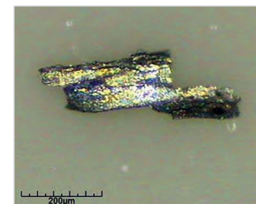
Particelle di metallo del filetto della vite
